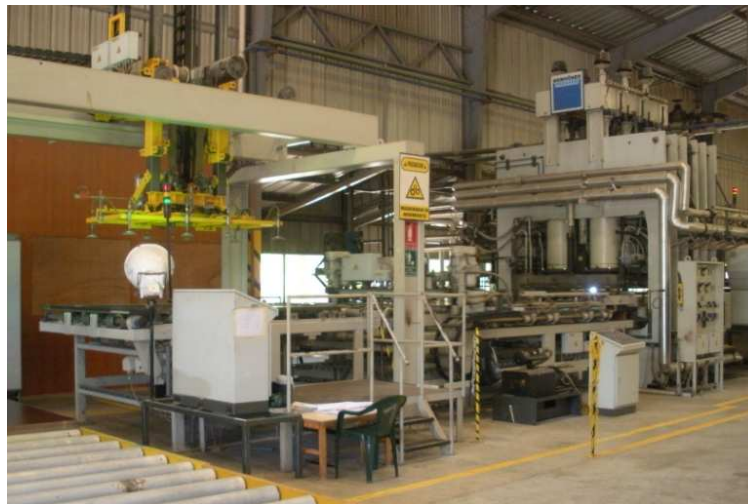
Ilustración No. 9 Prensa de melamina
