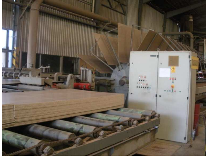
Ilustración No. 25 Enfriadora
