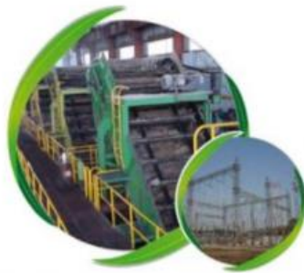
13. EXTRACCIÓN Y MOLIENDA SEPARA EL JUGO DEL BAGAZO PARA GENERACIÓN DE ENERGÍA
