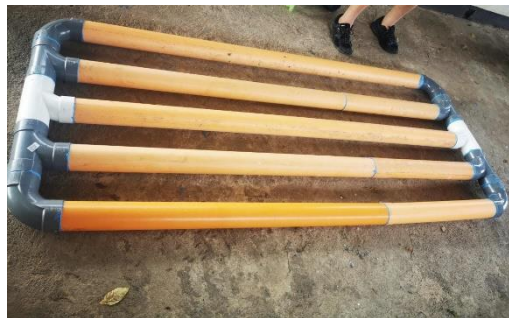
Ilustración 22 Tubos y codos armados para paso de agua
