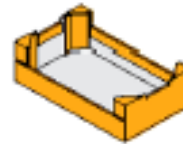
Bandeja con ángulos y pared doble en la parte superior y laterales
