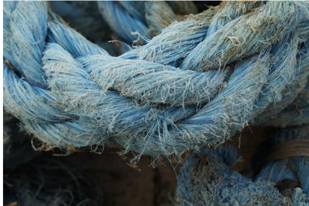
Ilustración 20 desgaste y deterioro de cuerdas
